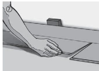
⑦ Start med resten af det afskårne stykke fra første række i den næste række (enderne skal forskydes min. 50 cm). Derved reduceres spildet meget. Lægningen fortsættes element for element. Først drejes elementerne på langs ind i samlingen med et let tryk.
